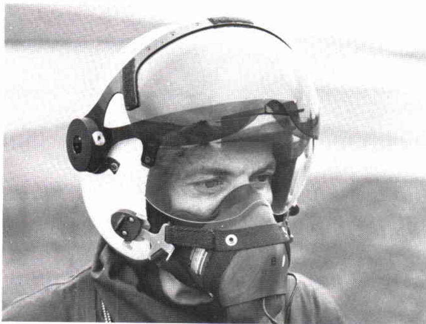
Den modifierade flyghjälm med dubbelvisir, som kommer till våren. Det nedfällda, klara visiret manövreras med höger hand och det färgade solskyddet med vänster. Foto: Niklas Forslind.
