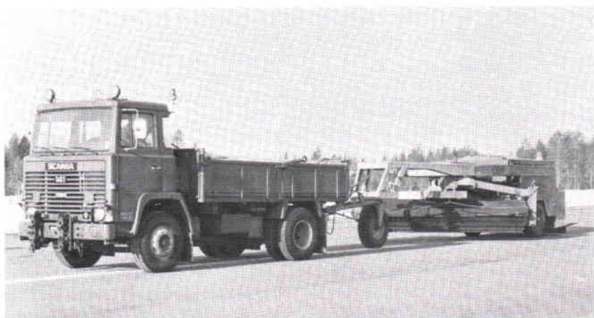
Dragbil Scania 141 med sopblåsmaskin Schörling P 17.
