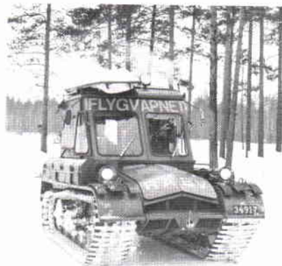
Räddningsbandvagn Showtrac St 4, för transport av skadade i svår terräng.
