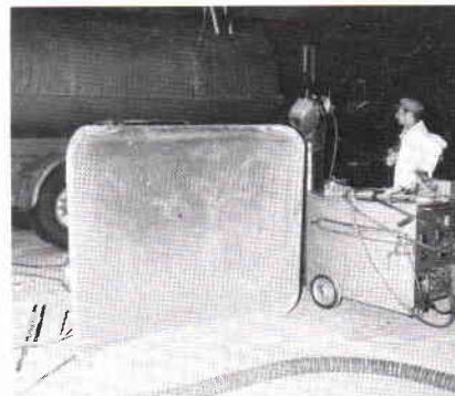
En tre kvadratmeter stor plåt fick passas till och svetsas på plats. Ett svårt jobb, men resultatet blev bra.
